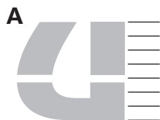
Figura A: Nesta situação, a letra é dividida em sete partes iguais no total de sua altura. O que se obtém a partir desta divisão é a medida da unidade que irá receber uma nova divisão.
