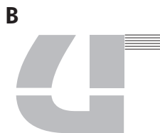
Figura B: Nesta outra, toma-se a última medida resultante do procedimento anterior, e então a dividimos em cinco partes iguais. O resultado desta divisão é que será a nossa unidade de definição de todo o espaçamento.
